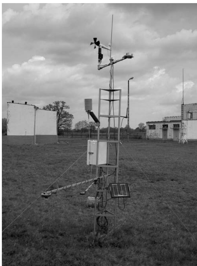
Ryc. 8. Automatyczna stacja meteorologiczna wykorzystana do zgromadzenia informacji o wybranych elementach meteorologicznych Fig. 8. The Automatic Weather Station used for collecting meteorological data in the city of Wrocław climate researches
