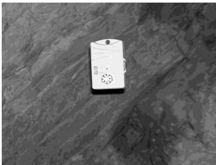
Ryc. 28. Automatyczny rejestrator temperatury i wilgotności względnej powietrza typu „Čierna skrinka” firmy Comet Systems Ltd (fot. K. Strug).
