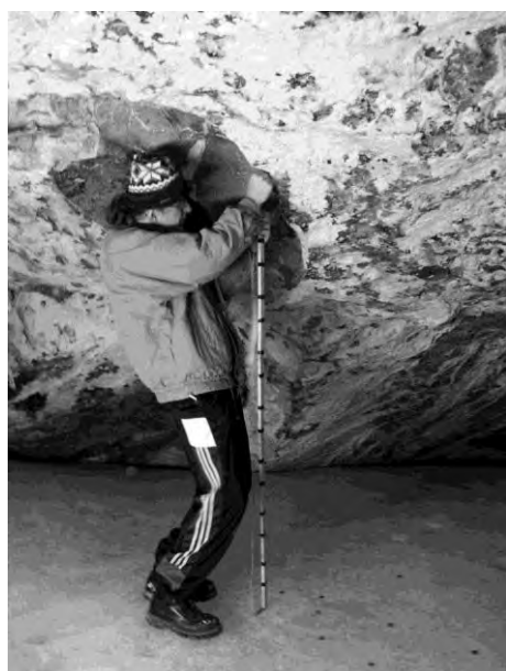
Ryc. 24. Pomiar odległości między stropem jaskini i powierzchnią lodu dennego w Demänovskiej JL w sali Kmeťov dóm (fot. R. Szmytkie, za zgodą autora).
