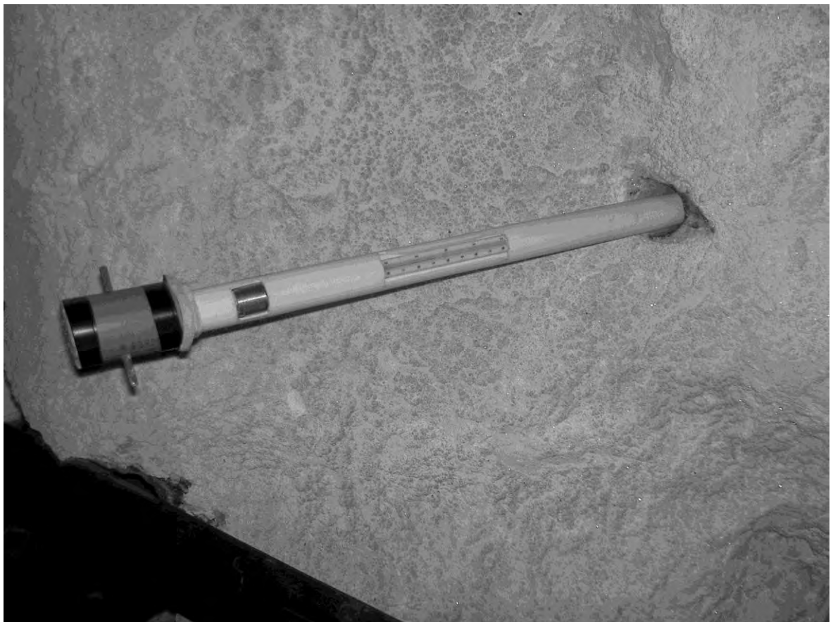
Ryc. 39. Termometr Augusta zamocowany w rurze wyciągowej w Demänovskiej JL w sali Štrkový dóm (fot. K. Strug).
