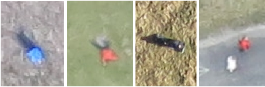
Ryc. 12. Ludzie zarejestrowani przez kamerę cyfrową w zakresie światła widzialnego Canon S110 o matrycy 12 MP, w którą standardowo wyposażony był bezzałogowy statek powietrzny eBee. Przybliżona terenowa wielkość piksela wynosi 4–5 cm.
