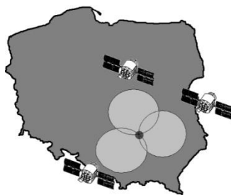
Ryc. 1. Schemat lokalizowania obiektu za pomocą trzech satelit. Źródło: Kryszczuk, Starus 2012.
