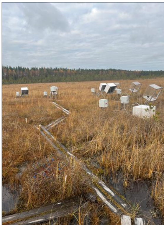
Aparatura badawcza do pomiaru strumieni \text{CO}_2 i \text{CH}_4 na torfowisku w Siikaneva.
