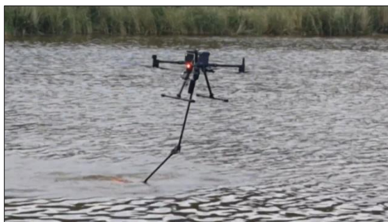
Badania batymetryczne przy pomocy echosondy (źródło: SPH Engineering).
