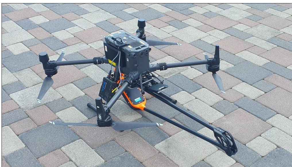
Echosonda EchoNIMBUS-MBES zamontowana pod DJI M300 (źródło: SPH Engineering).
