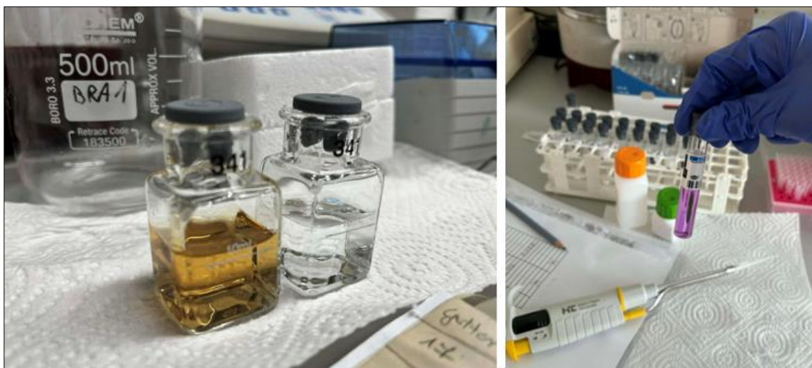
Analizy kolorymetryczne próbek wody na zawartość azotanów oraz twardość wody.
